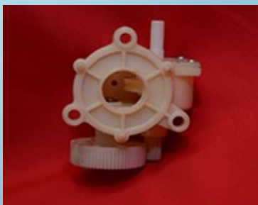
#30.4| TABLE FAN GEAR BOX BAJAJ TYPE
